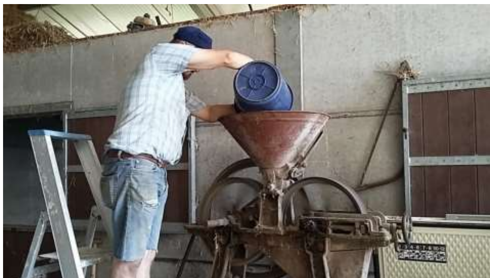
Figuur 24 : gebruik kleine pletmolen voor het pletten van de veldbonen
