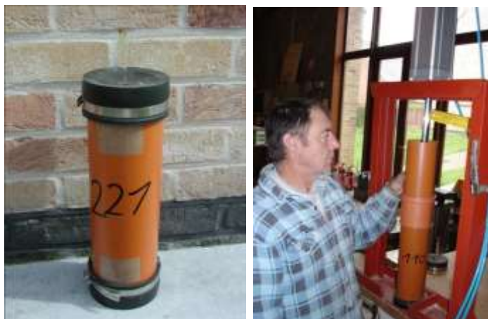
Figuur 25: gebruik microkuilen voor het inkuilen van de geplette deegrijpe veldbonen (Proefhoeve Bottelare)
