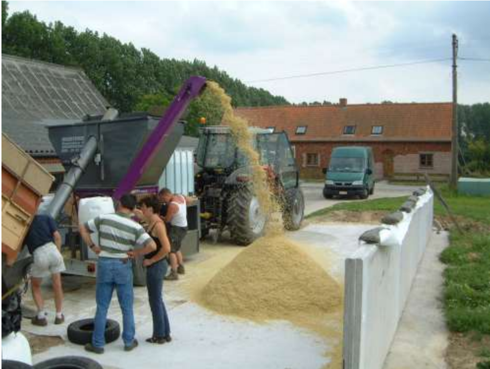
Figuur 22 : Voorbeeld pletten van veldbonen volgens het crimpen-procedé (pletten) met toevoeging van een kuiladditief (Proefhoeve Bottelare, Proef PE 17.02)
