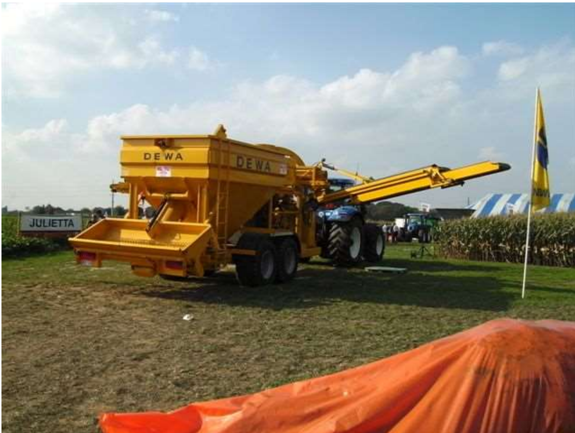
Figuur 23 : Voorbeeld van hamermolencombinatie zoals ook gebruikt bij het malen van CCM
